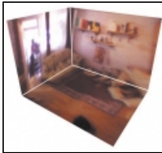
A két képen a szobáról készült gömbtükrös kép alapján feltextúrázott téglatestek láthatóak.
